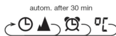
Si en los menús "Altimetro", "Despertador" y "Temperatura" no se pulsa el emblema Victorinox durante un lapso de tiempo más de 30 minutos, en la pantalla se vuelve a visualizar automáticamente el modo de indicación de la hora.
