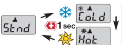
La visualización pasa automáticamente al "modo de corrección del tiempo". Al pulsar brevemente el emblema Victorinox, el ajuste de corrección se puede modificar en el orden "Std", "Cold", "Hot".
