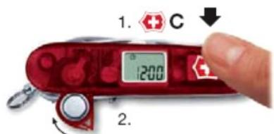
Al pulsar el emblema Victorinox cuando se cierra el compartimiento de la pila, se pasa al sistema americano (altitud = ft, temperatura = °F, hora = 12h). La prueba de las funciones se efectúa tal como se indica más arriba.
